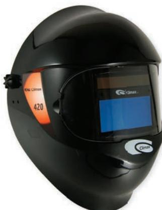
Cagoule de soudage avec filtre opto-électronique, alimentation : cellules solaires et batterie au lithium, échelle de l'assombrissement 9 - 13, niveau d'assombrissement réglable, durée de fonctionnement réglable.
